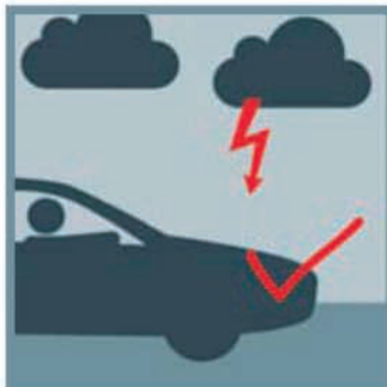
Fig.23 Un refugio seguro es el automóvil. La mayoría de la gente cree que es por las gomas que aíslan el auto del suelo .Están equivocados. Es porque un automóvil con carrocería metálica, actúa como jaula de Faraday. La corriente del rayo se distribuye por la superficie externa de la carrocería metálica y se descarga a tierra, cortocircuitando las gomas. Manténgase quieto en el asiento, Las ventanillas y las puertas deben permanecer cerradas
